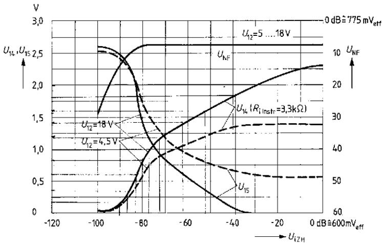
**NF-Ausgangsspannung, Störspannung**  $U_{NF}, U_{Stör} = f(U_{iZF})$
